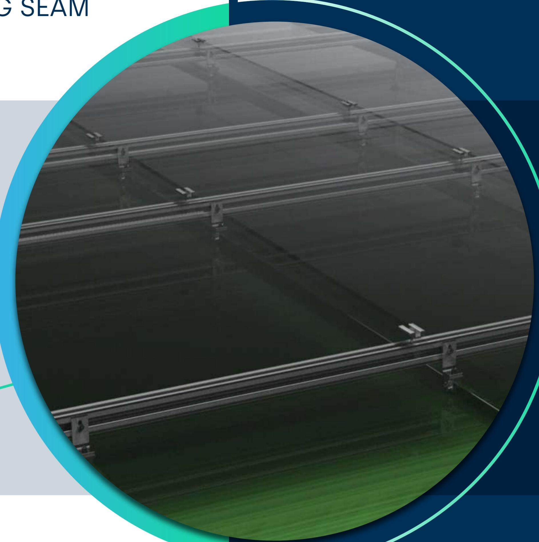
El diseño de la estructura está compuesto por un accesorio que se fija en las pestañas de las tejas grafadas llamado Gclamp\* este puede ser de dos tipos, para tejas con pestañas convencionales (calibre menor a 8,7 mm) y para tejas con pestañas más anchas de máximo 17 mm, en conjunto con una "L", un Mrail y los accesorios de fijación del panel Eclamp y Mclamp.
